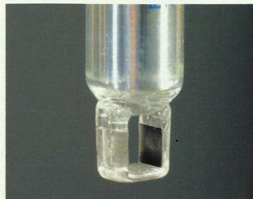
Doc. 8 Cellule conductimétrique.
