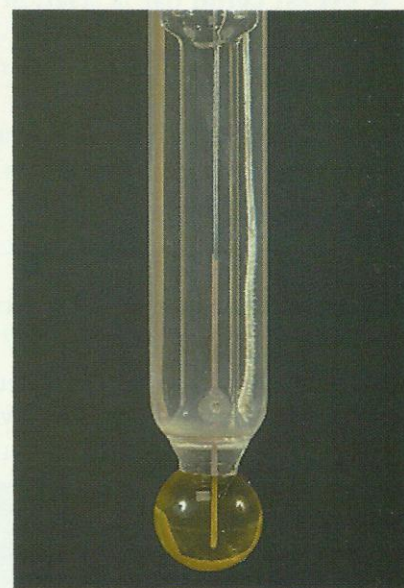
Doc. 6 Sonde de mesure du pH.
